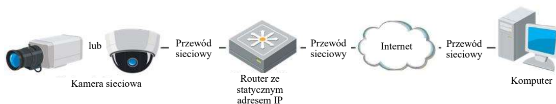
Rysunek 0–10 Uzyskiwanie dostępu do kamery przez router ze statycznym adresem IP
